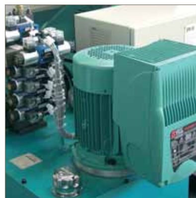
Groupe hydraulique destiné à l'entraînement de machines de transformation de la tôle (plieuses à tablier long) équipé de moteur avec convertisseur de fréquence intégré, type Varmeca de Leroy-Somer. Toutes les fonctions, l'accélération, le freinage ainsi que les différents mouvements de vitesse sont commandés par le convertisseur de fréquence Varmeca monté sur le moteur de la pompe.
