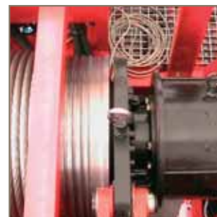
Motore HPM integrato nel tamburo di sollevamento
