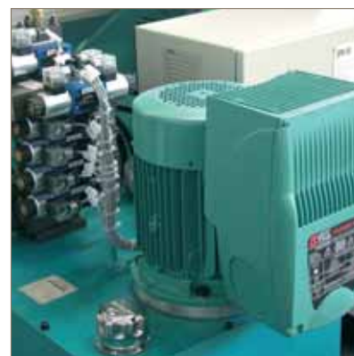
Gruppo idraulico destinato alle macchine per la piegatura della lamiera dotato di motore con driver integrato, tipo Varmeca di Leroy-Somer. Tutte le funzioni, l'accelerazione, la frenatura nonché i diversi movimenti di velocità sono gestiti dal driver Varmeca montato sul motore della pompa.
