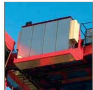
Inversor Powerdrive em armário de aço inoxidável
