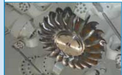
*Verschiedene Ansichten der Kraftwerke von Ytre Alsåker kraftverk und Årvik (Norwegen): beide sind jeweils mit einem Generator LSA 58 mit vertikaler Achse, 5490 kVA, 6600 V, 600 min<sup>-1</sup>, mit 6-strahliger Pelton-turbine ausgestattet, die freitragend auf die Generatorwelle montiert ist.*
