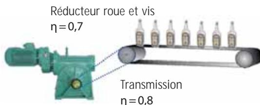
Rendement mécanique total :  $0,7 \times 0,8 = 0,56$
