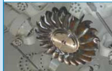
*Différentes vues des centrales électriques de Ytre Alsåker et de Årvik (Norvège) qui comprennent chacune un alternateur LSA 58 à axe vertical, 5490 kVA, 6600 V, 600 tr/min, avec une roue turbine Pelton - 6 jets - montée en porte-à-faux sur l'arbre de l'alternateur.*
