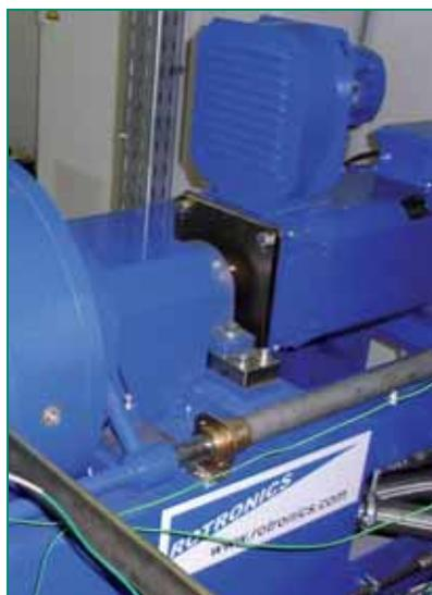
Com um índice de protecção IP23 e uma ventilação permanente auxiliar independente da velocidade da máquina, eles podem funcionar em serviço contínuo a velocidades reduzidas.
