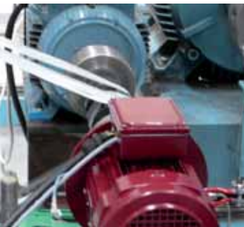
Abbildung 1 – Aufbau einer Messvorrichtung (5,2 kW Permanentmagnetmotor, Drehmomentmesser und Generator)
