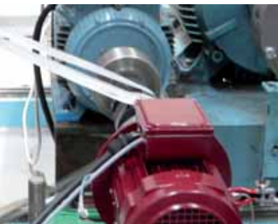
Figur 1 – Måleopstilling (5,2 kW PM-motor, momentmåler og generator)
