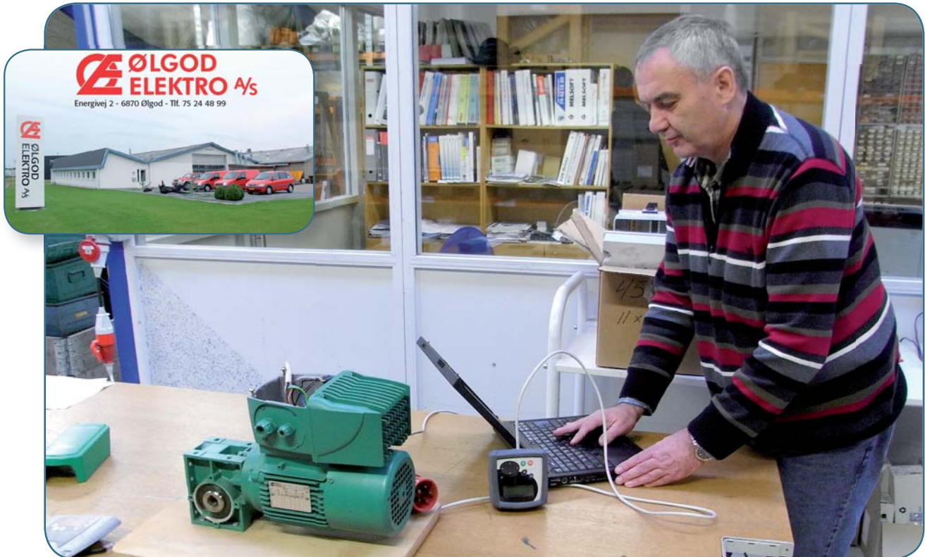
Drivestekniker Hans Schmidt omprogrammerer en LS Varmeca hos Ølgod Elektro.
