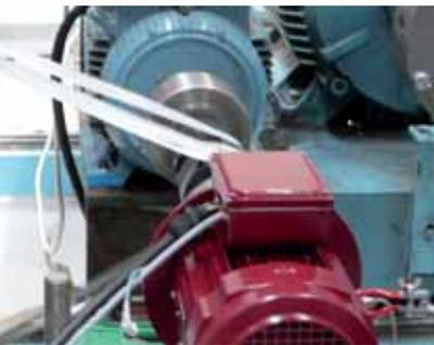
Figura 1 – Installazione di un apparecchio di misurazione (motore PM da 5,2 kW, misuratore di coppia e generatore)
