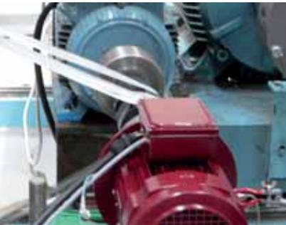
Figura 1 – Montaje de equipos de medida (motor PM de 5,2 kW, medidor de par y generador).
