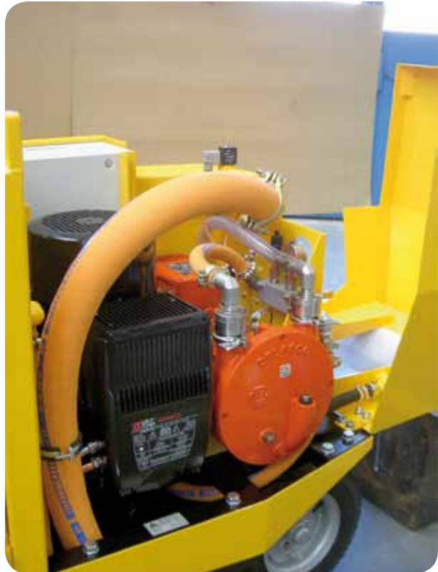
Betonspritzmaschine mit zwei integrierten Varmeca-Drehzahlreglern von Leroy-Somer. Einer dieser Regler steuert die Drehzahl des Motors (auf dem Foto in Schwarz), der andere die Dosierpumpe (auf dem Foto in Orange). Die Kombination der beiden Drehzahlregler ermöglicht dem Benutzer eine hohe Genauigkeit bei der Herstellung des Betongemisches.
