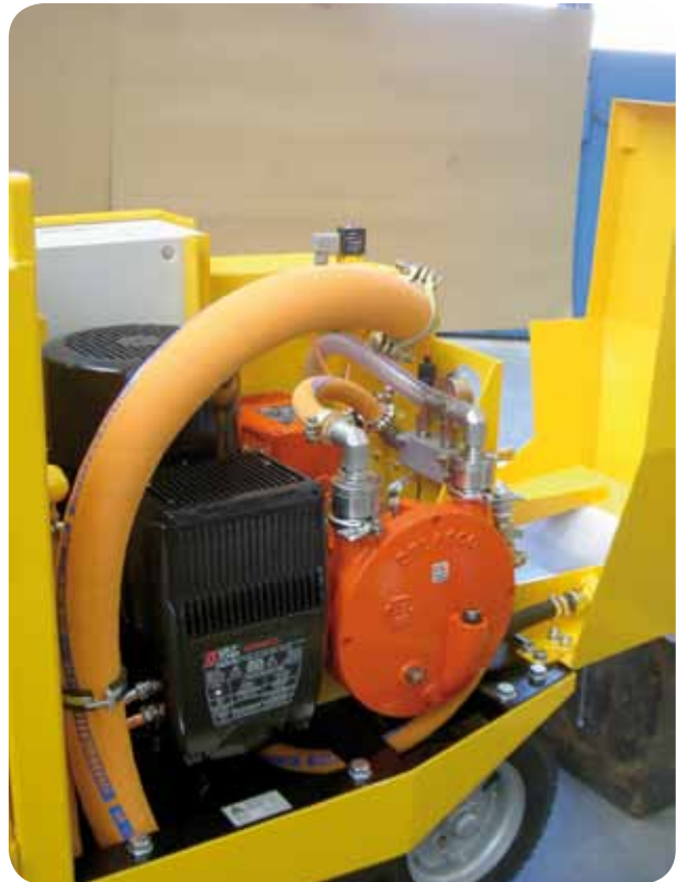
Machine à projeter le béton équipée de 2 variateurs intégrés Varmeca de Leroy-Somer. L'un pour gérer la vitesse du rotor (en noir sur la photo), l'autre pour gérer la pompe de dosage (en orange sur la photo). La combinaison des 2 variateurs permet à l'utilisateur d'avoir une grande précision de son mélange béton.
