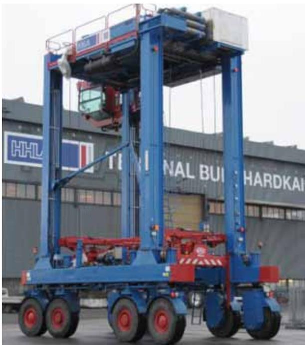
Leroy-Somer a participé au développement d'un chariot cavalier électrique révolutionnaire, entièrement équipé de systèmes de commande électrique pour le déplacement et le levage des conteneurs.
