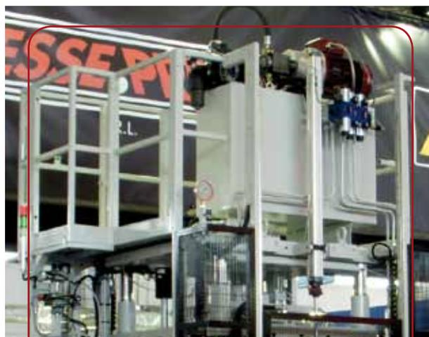
*Il peso e dimensioni ridotte del motore LSRPM ne facilitano l'installazione sulla testa della Pressa*
