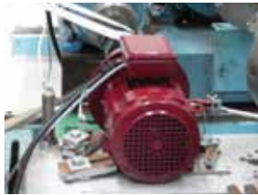
Figura 1 – Configuração do equipamento de medição (Motor IM 5,2 kW, medidor de binário e gerador)
