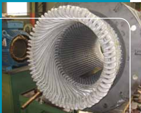
Rebobinage du stator d'un moteur Moyenne Tension
