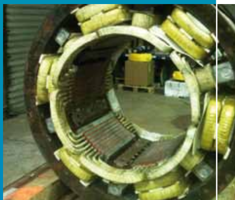
Herwikkeling van een gelijkstroommotor van 150 kW – 600 min -1 – 440 V
