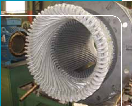
Herwikkeling van de stator van een middenspanningsmotor
