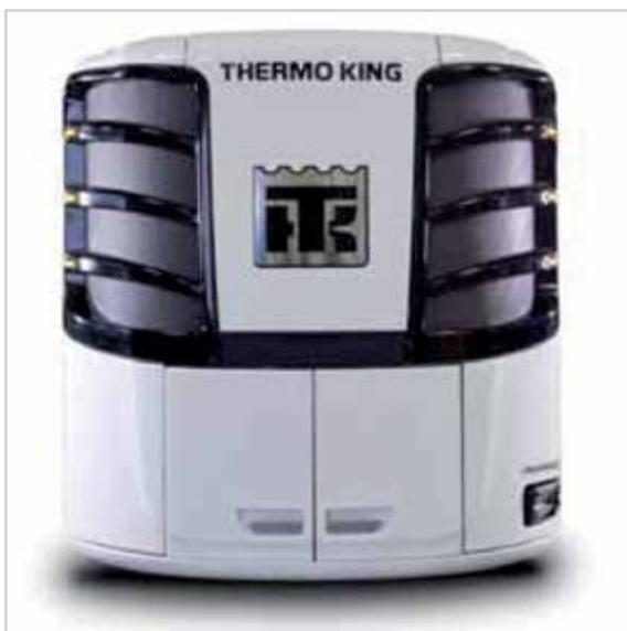
Para cumplir con la norma Tier 4 (EE. UU.) sobre emisiones de gas para motores diésel no destinados al transporte por carretera, Thermo King ha desarrollado un nuevo sistema de refrigeración para los remolques de camiones frigoríficos, denominado "Precedent™", que permite ahorrar carburante.
