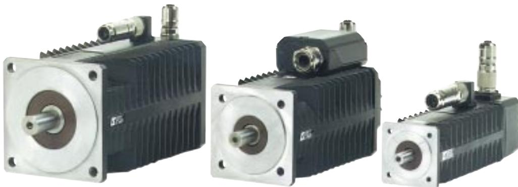
La gamma dei servomotori SMV UM LEROY SOMER, sfrutta una concezione della carcassa, innovativa per i motori di tipo autosincrono. L'alettatura di questa risulta infatti inclinata di 45° rispetto all'asse del motore, conferendo così al motore una capacità di scambio termico superiore di circa il 200% rispetto a quella realizzata dall'alettatura tradizionale. Questo si traduce in un aumento sensibile del rapporto coppia/volume.
