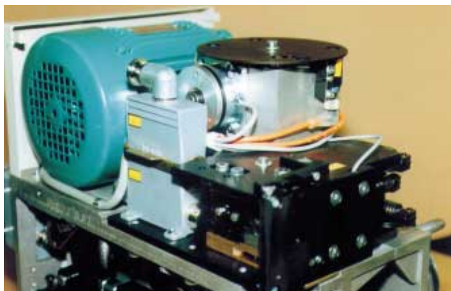
Bild 2: Cyklop-Umreifungsaggregat CFH-1 mit Leroy Somer Motor LS 80
