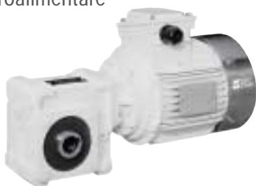
Il principale nemico dei motoriduttori, nel settore agroalimentare, è la corrosione. La nuova gamma di riduttori a ruota e vite senza fine Multibloc 2000 IA e il CB 3000 presentano numerose e importanti innovazioni: riduzione delle zone di accumulo dell'acqua, rafforzamento delle tenute meccaniche e dei collegamenti elettrici, eliminazione dell'ossidazione per attrito.
