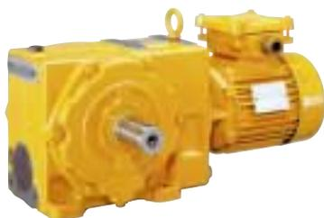
Le nuove gamme di motoriduttori dotati di motori LSPX/FLSPX, con o senza freno, sono state sviluppate per funzionare in ambienti di stoccaggio di prodotti organici che liberano polveri infiammabili (cereali, grassi, prodotti alimentari...). Comprendono potenze che vanno da 0,09 a 400 KW. Conformi alle prescrizioni ATEX 94/9/CE, le loro caratteristiche sono la garanzia di temperatura superficiale massima (125°C) e di tenuta alle polveri (Protezione IP 65).
