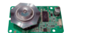
High Speed Polygon Laser Scanner (Aerodynamic) 高速ポリゴンレーザスキャナ(空力動圧型)
