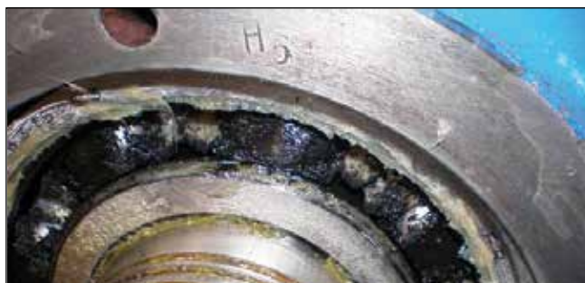
Illustration 7 - Graisse de roulement noircie suite à un échauffement dû à de multiples décharges
