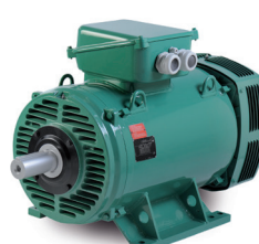
PLSES IE2 - IE3 ODP / IP23 Hauteur d'axe de 225 à 450 mm 2, 4 ou 6 pôles De 55 à 900 kW
