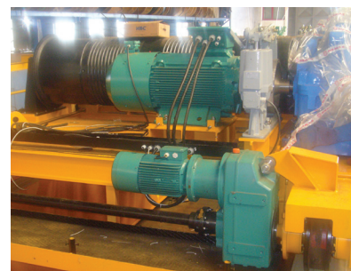
Mouvement de direction Motoréducteur à engrenages hélicoïdaux avec frein intégré, sortie parallèle à arbre creux
