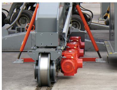
Mouvement de translation Motoréducteur à engrenages hélicoïdaux avec frein intégré, entraînement par frette de serrage
