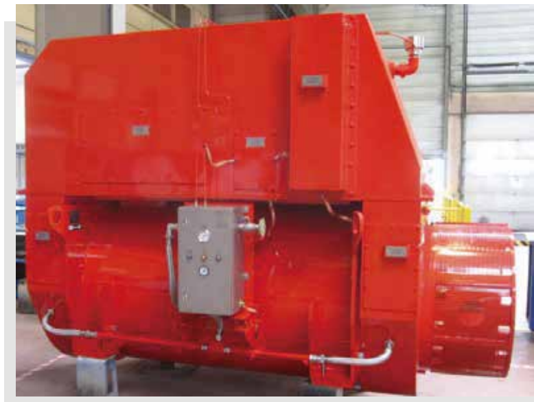
应用于海上石油开采的室内加压水冷发电机
