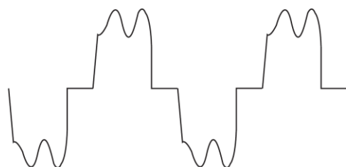
Courant de ligne consommé par un redresseur triphasé
