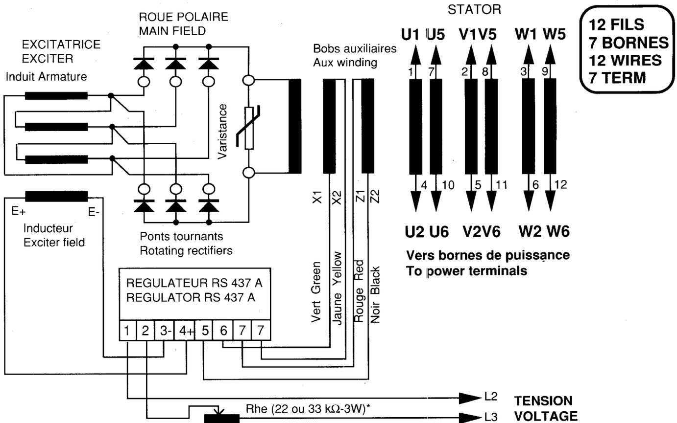
\* OPTION : Ajustage de tension extérieur - \* OPTIONAL : Remote voltage trimmer
