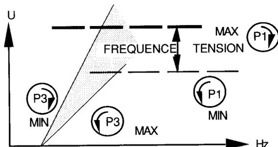
Potentiomètre (P1) Tension MAXIMUM à fond à droite
