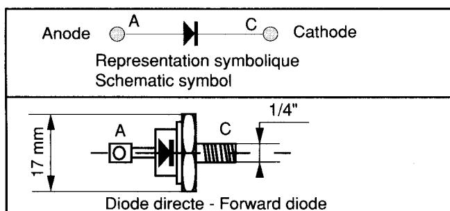
Une diode en bon état doit laisser passer le courant uniquement dans le sens anode vers cathode.
