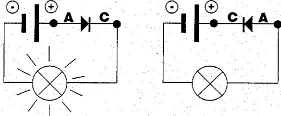
Une diode en bon état doit laisser passer le courant uniquement dans le sens anode vers cathode.
