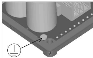
Pour la sécurité de l'utilisateur, le D550 doit être relié à une mise à la terre réglementaire au moyen de la borne de terre représentée ci-dessus.
